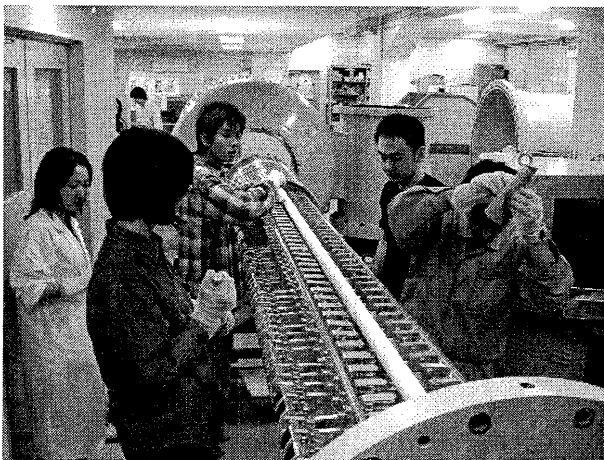
写真2 高電圧の整流・昇圧装置の点検
